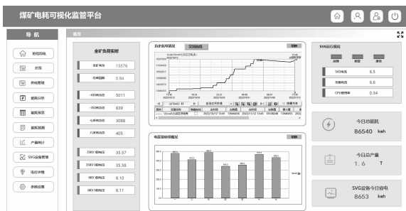
图 7 基于组态王的煤矿负荷监控平台
