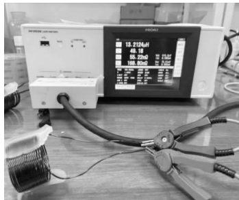
图8 1 mm 线径线圈电感测试
