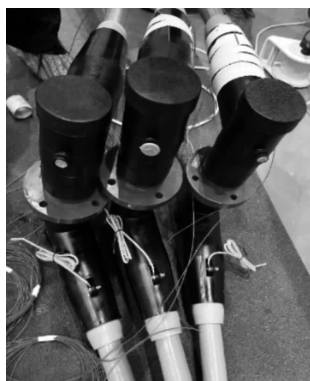
(b) 试验回路及测温传感器实际布置图
