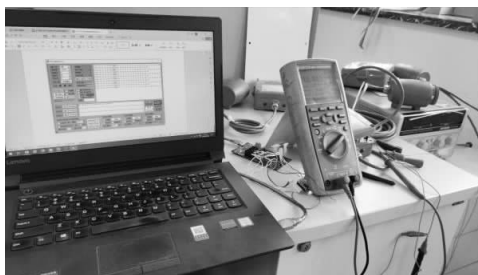
图 5 传感器传输性能测试
