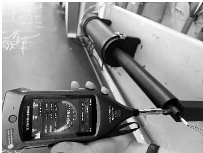
图 10 传感器测试图
