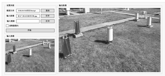
图 8 气象雨量筒异物检测预警系统界面展示
