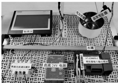
图 7 恒温热水器实验系统
