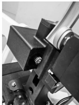
图 15 样机 - 送带模块
